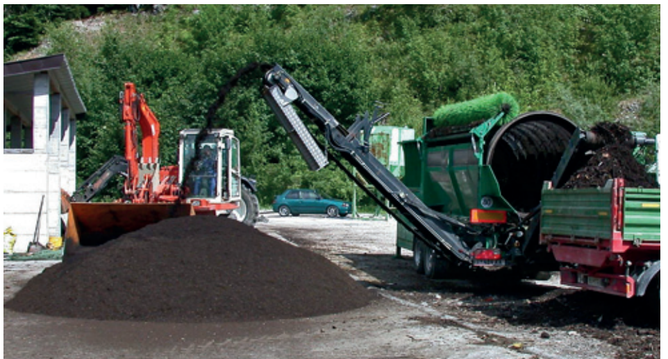
Durch den Einsatz des mobilen Kompostsiebes entsteht feine und qualitativ hochwertige Komposterde.
